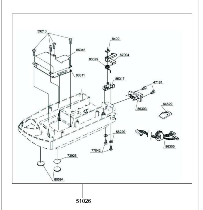
Nº DA PEÇA OU Nº DA PEÇA OU DESCRIÇÃO DESCRIÇÃO CONJUNTO CONJUNTO 8400 ANEL DE RETENÇÃO E5 77042 PARAFUSO PHILLIPS M4 PARAFUSO M3 CONECTOR 39213 86303 47181 **PARAFUSO** 86305 CHICOTE **AUTO-ATARRACHANTE** 86311 PLACA DE CIRCUITOS 58220 **ARRUELA** 86317 **APOIO** PLACA DE PÉ DE BORRACHA TORÇÃO 60594 86329 MOLA DE 64629 GUIA DO CORDÃO 86346 TAMPA DA PLACA 73926 **ESPAÇADOR** 87004 ALAVANCA LIBERADORA 18
