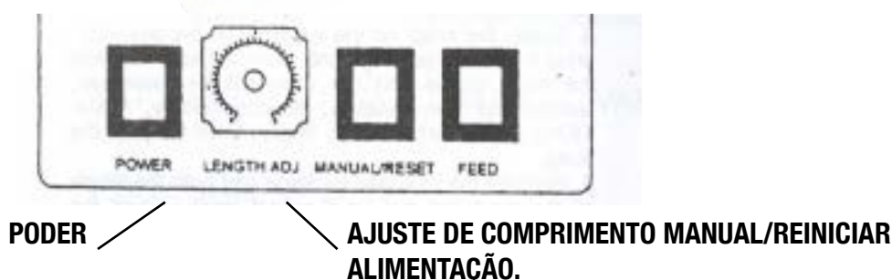
FIGURA 6. PAINEL DE CONTROLE DO OPERADOR
