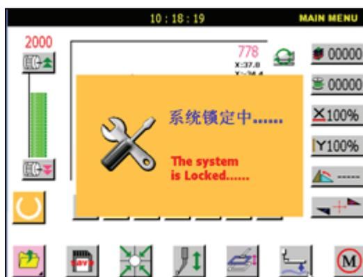
Todas as operações estarão travadas para proteger o operador que for fazer ajustes no equipamento ou manutenção; após soltar o botão de pause, as operações serão restauradas.
